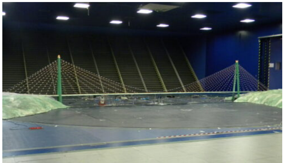
Modello aeroelastico del Ponte Yavuz Sultan Selim
